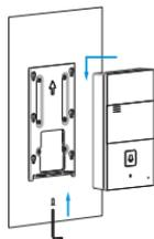
1. Потяните устройство вниз, чтобы надежно его зафиксировать.
