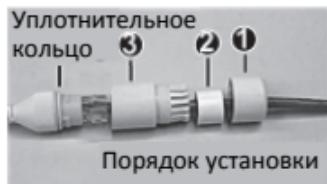
Прикрепите уплотнительное кольцо к интерфейсу Ethernet. Установите водонепроницаемые компоненты в указанном порядке. Вставьте кабель в интерфейс Ethernet и закрутите водонепроницаемый болт.
