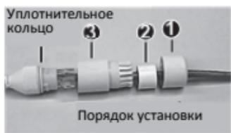
Прикрепите уплотнительное кольцо к интерфейсу Ethernet. Установите водонепроницаемые компоненты в указанном порядке. Вставьте кабель в интерфейс Ethernet и закрутите водонепроницаемый болт.
