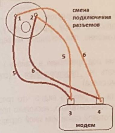
При наличии одного разъема на модеме – к каждому разъему антенны, по той же процедуре.
