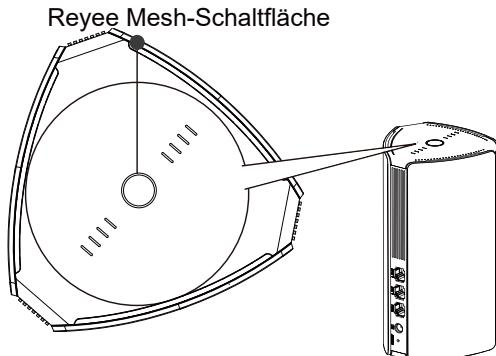
**4. Verschieben Sie den sekundären Router in einen Bereich, an dem eine Wi-Fi-Abdeckung benötigt wird, und schalten Sie ihn wieder ein**
