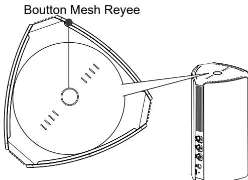
**4.Déplacez le deuxième routeur dans une zone où une couverture Wi-Fi est nécessaire et remettez-le sous tension.**
