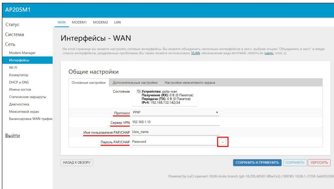
Рисунок 3.3.3 – Ввод данных для протокола подключения PPtP
