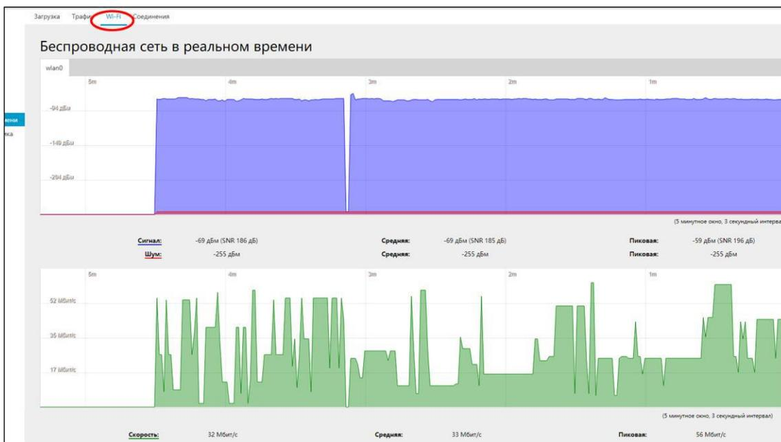
Рисунок 10.6.3 – График передачи данных по беспроводным сетям Wi-Fi
