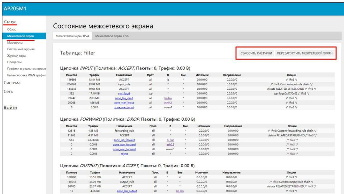
Рисунок 10.2.1 – Таблицы сетевого экрана и статистические данные
