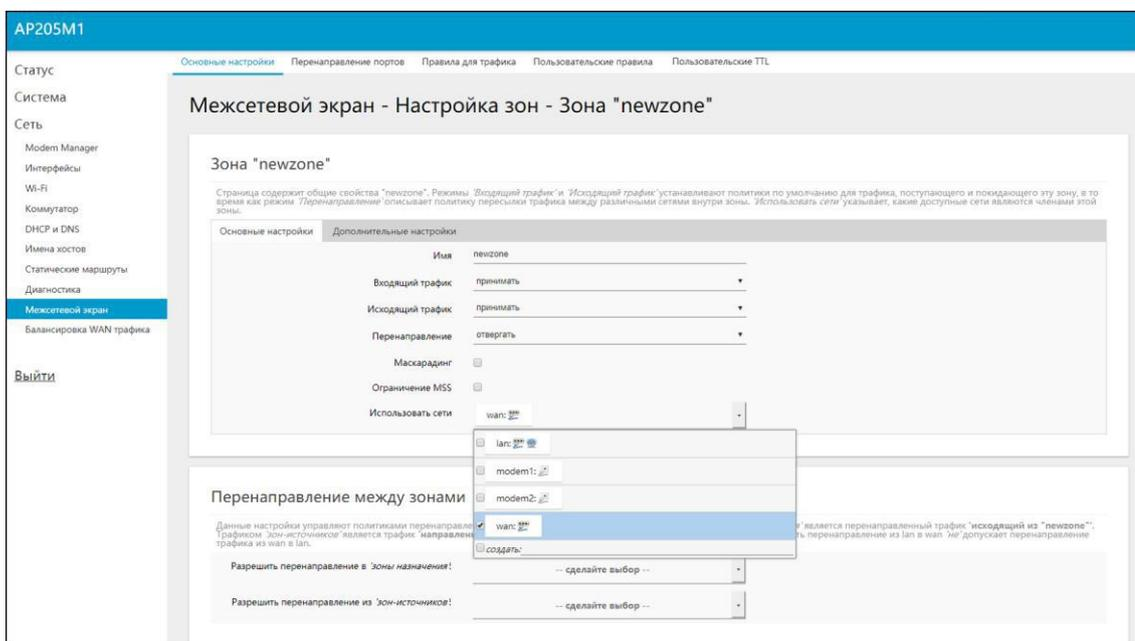
Рисунок 7.1.3 – Создание новой зоны сетевого экрана
