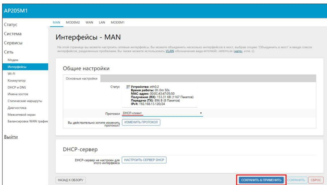
Рисунок 3.3.13 – Настройки интерфейса man с динамическим IP-адресом
