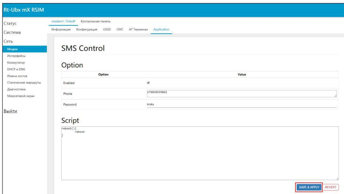
Рисунок 5.9.1.2 – Настройка опций управления роутером через SMS
