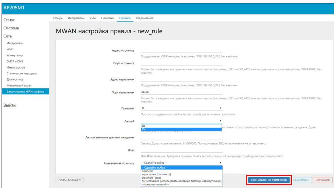
Рисунок 8.5.2 – Создание нового правила распределения трафика
