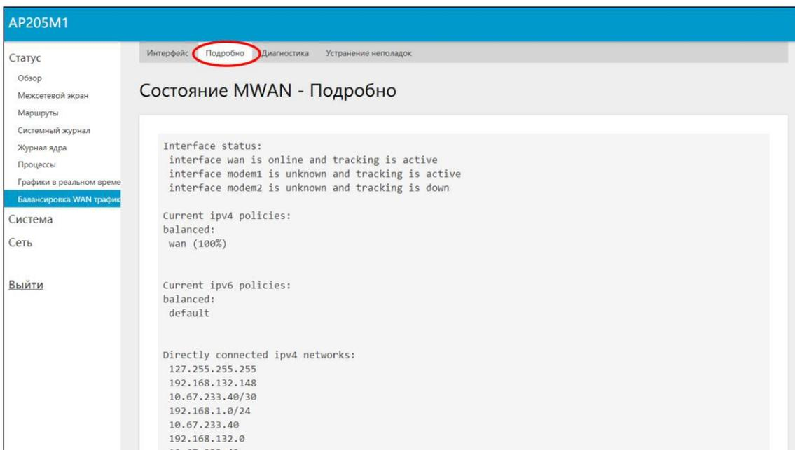
Рисунок 10.7.2 – Детальная информация о состоянии интерфейсов
