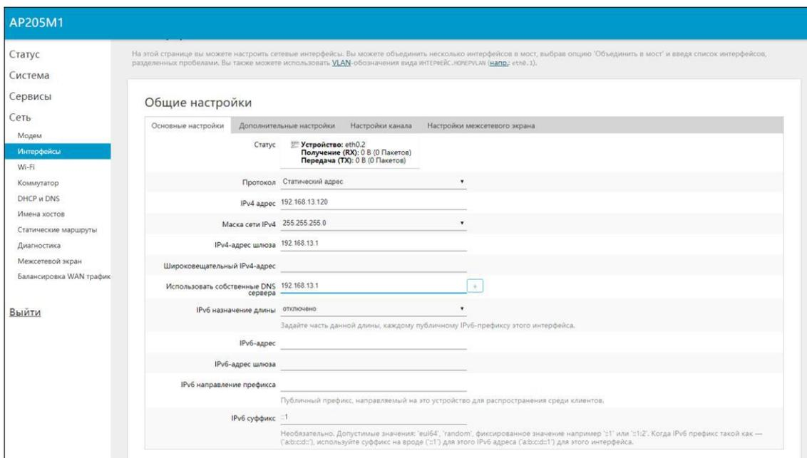
Рисунок 3.3.9 – Основные настройки интерфейса man со статическим IP-адресом
