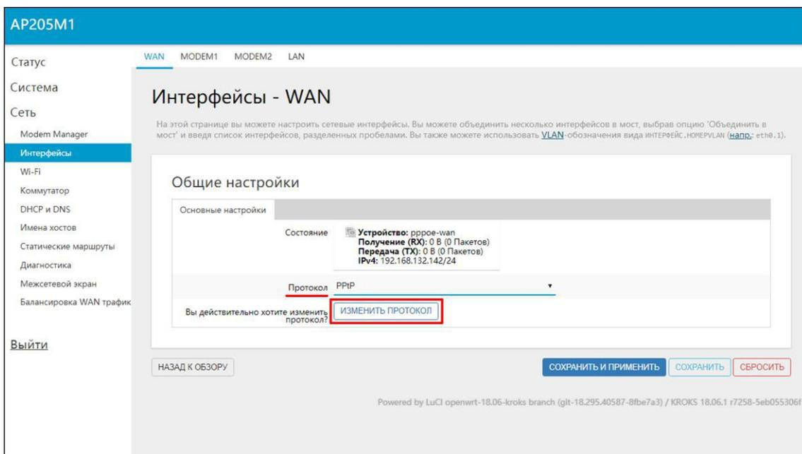
Рисунок 3.3.2 – Подтверждение выбора протокола подключения PPTP
