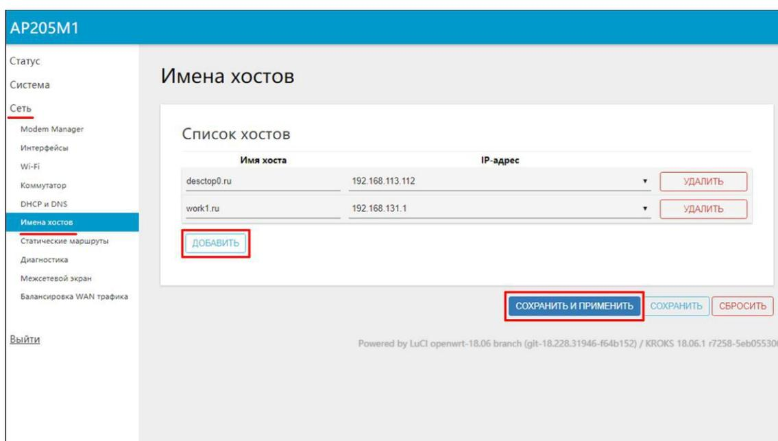
Рисунок 6.3.1 – Назначение доменных имен сетевым устройствам
