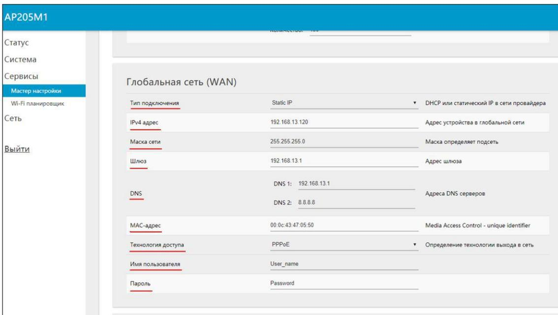
Рисунок 2.5.1 - Ввод данных для подключения по протоколу PPPoE со статическим IP-адресом
