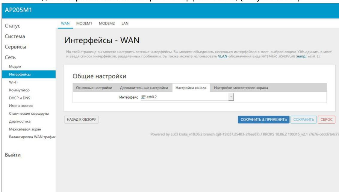
Рисунок 3.4.11 – Настройка канала соединения со статическим IP-адресом
