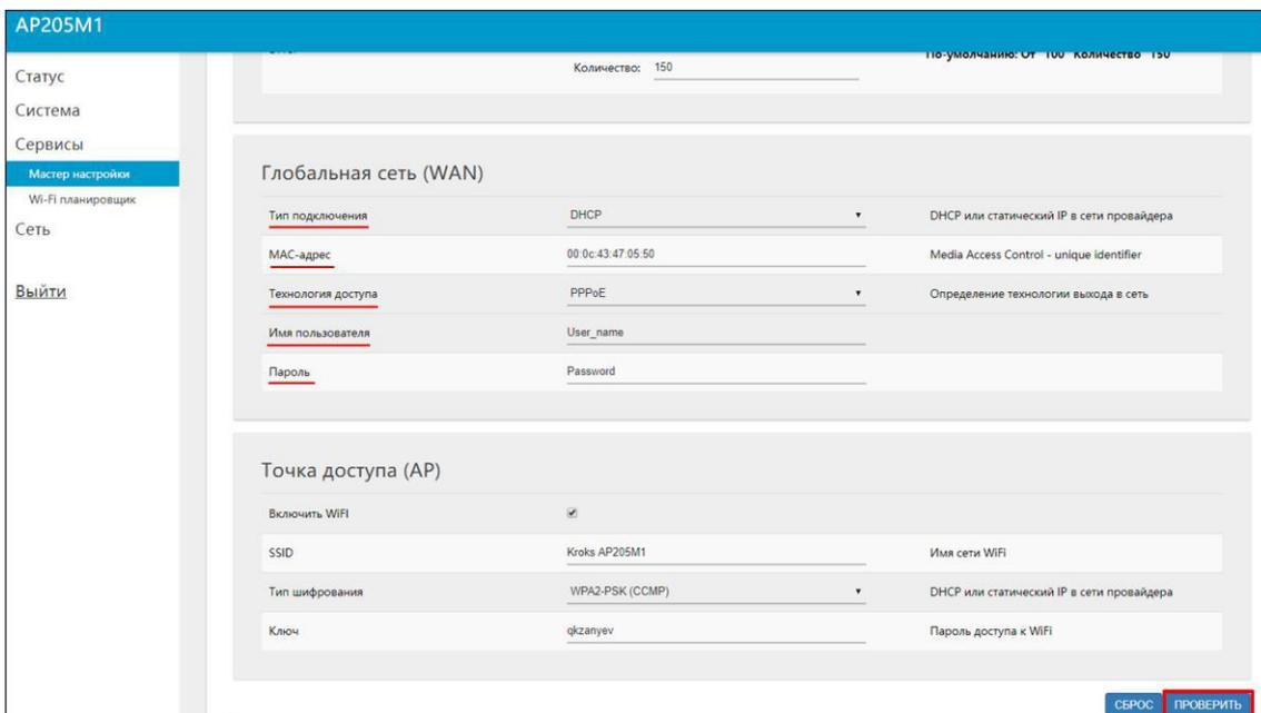
Рисунок 2.5.2 – Ввод данных для подключения по протоколу PPPoE с динамическим IP-адресом
