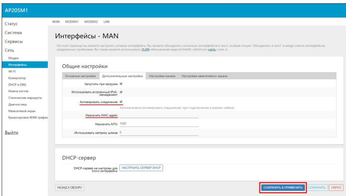
Рисунок 3.3.10 – Дополнительные настройки интерфейса man со статическим IP-адресом
