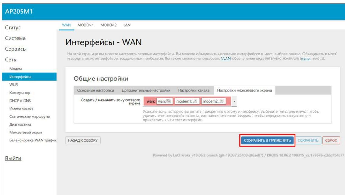
Рисунок 3.5.6 – Настройка зоны межсетевого экрана PPPoE соединения
