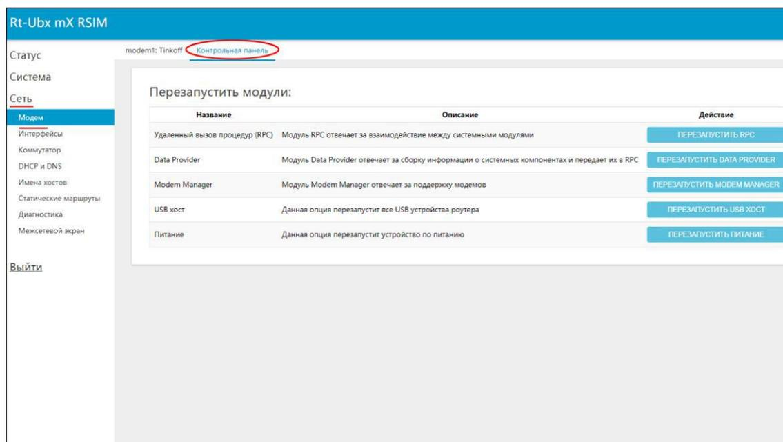
Рисунок 5.6.2 – Контрольная панель управления модемом роутера с SIM-инжектором
