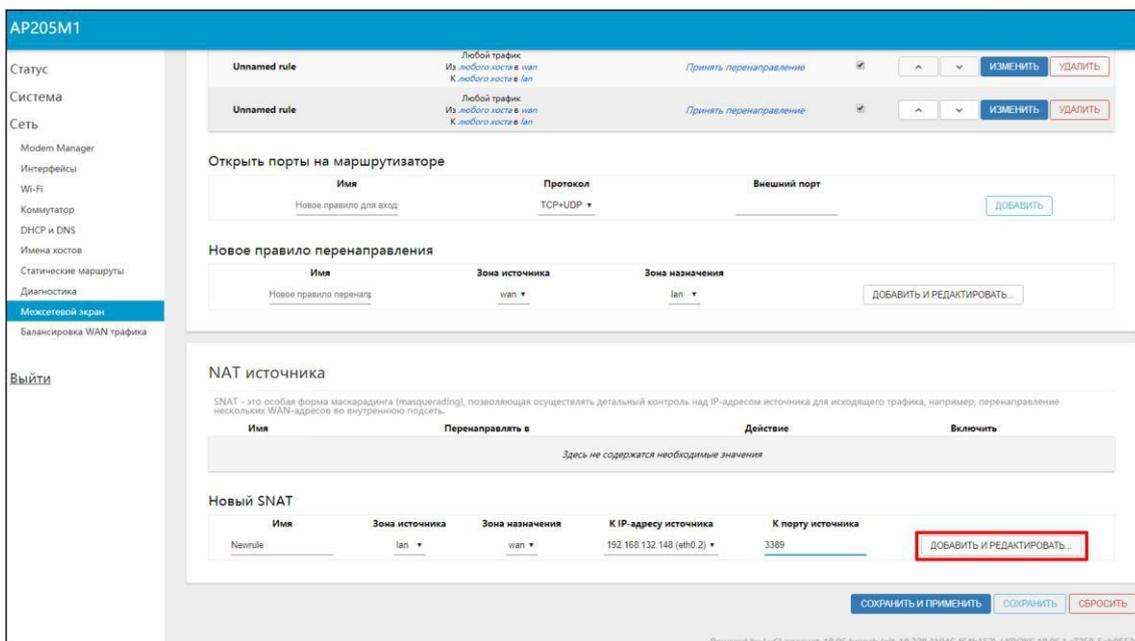
Рисунок 7.3.2 – Создание нового правила использующего метод SNAT
