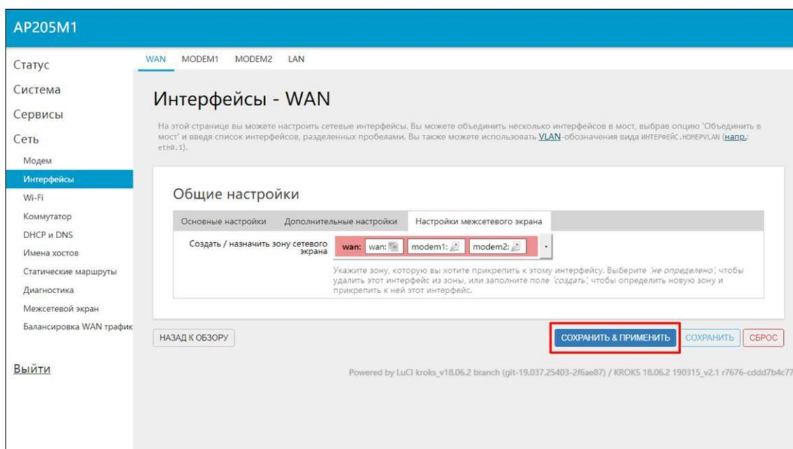
Рисунок 3.3.5 – Настройка сетевого экрана подключения по протоколу PPPoE
