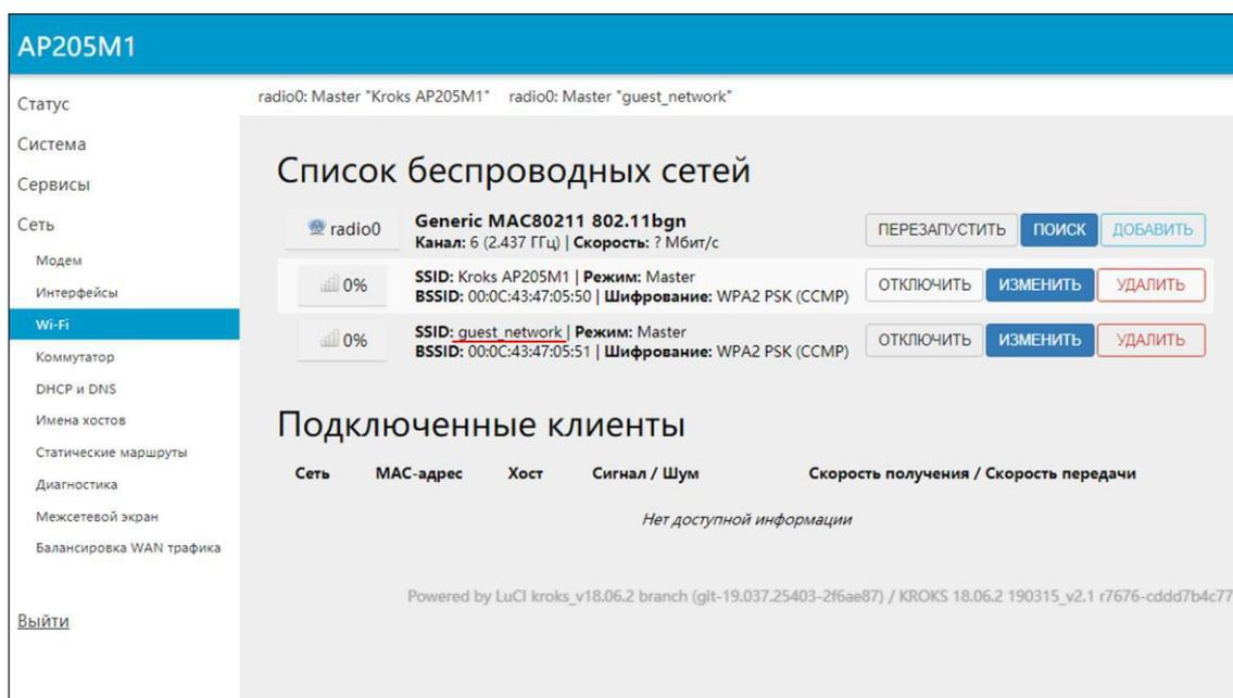
Рисунок 4.1.5 – Создана новая «Точка доступа» беспроводной сети Wi-Fi
