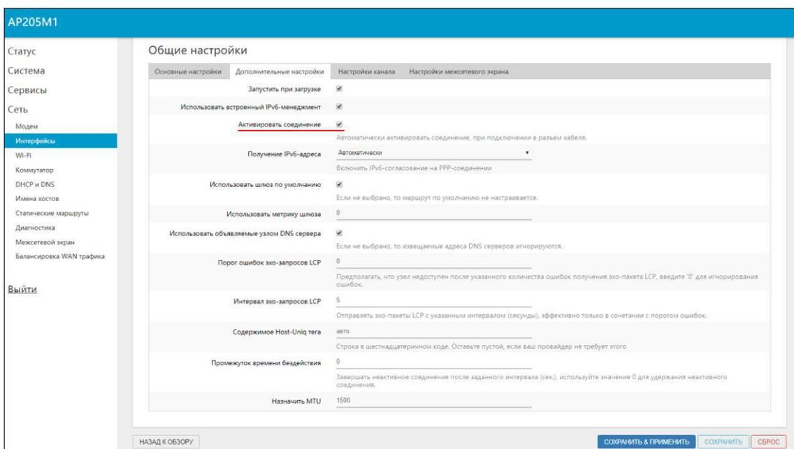
Рисунок 3.5.4 – Дополнительные настройки соединения по протоколу PPPoE
