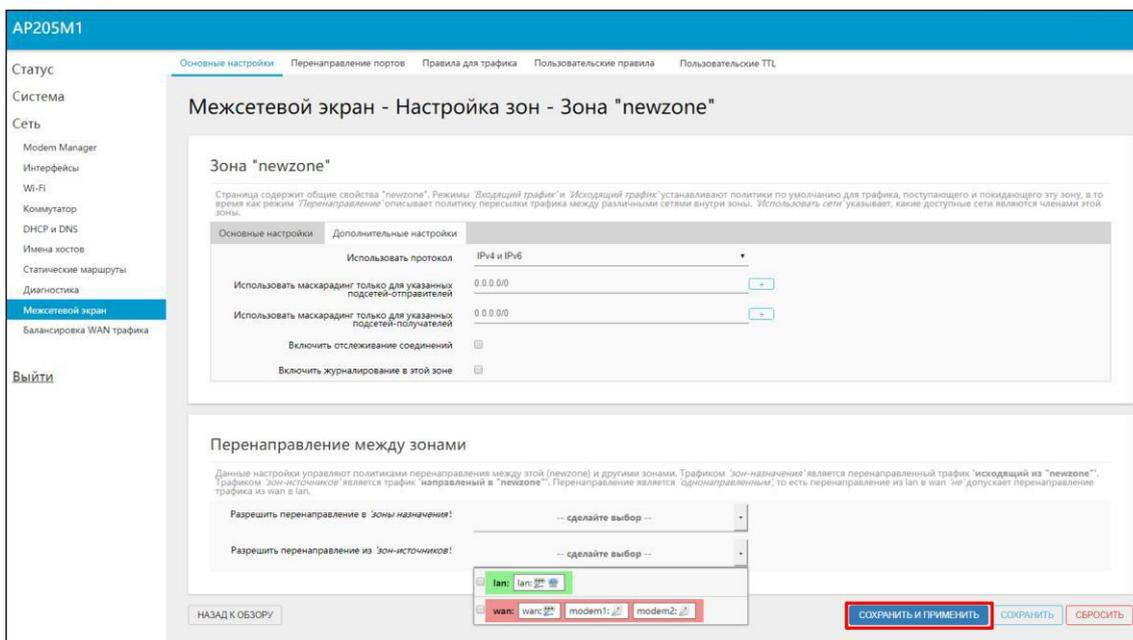
Рисунок 7.1.4 – Дополнительные настройки новой зоны межсетевого экрана
