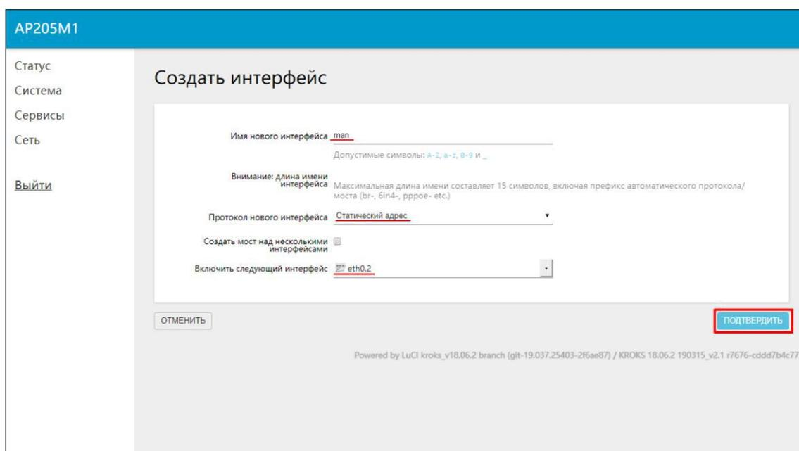
Рисунок 3.4.7 – Создание интерфейса man со статическим IP-адресом
