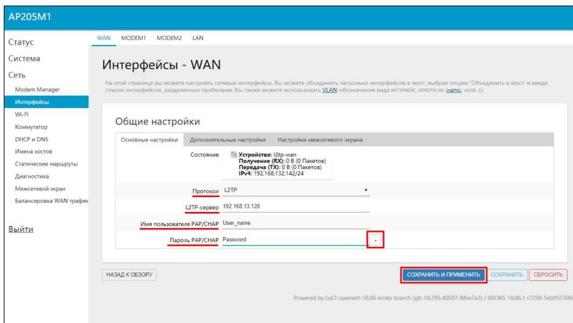
Рисунок 3.4.3 – Ввод настроек протокола L2TP подключения
