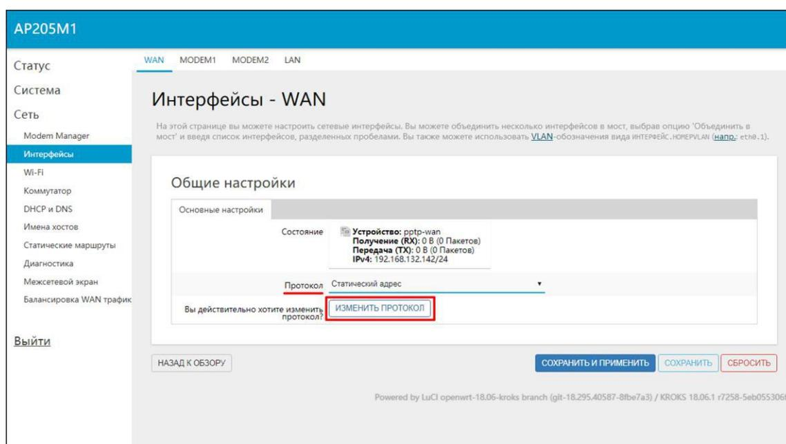
Рисунок 3.2.2. – Подтверждение выбора протокола подключения со статическим IP-адресом
