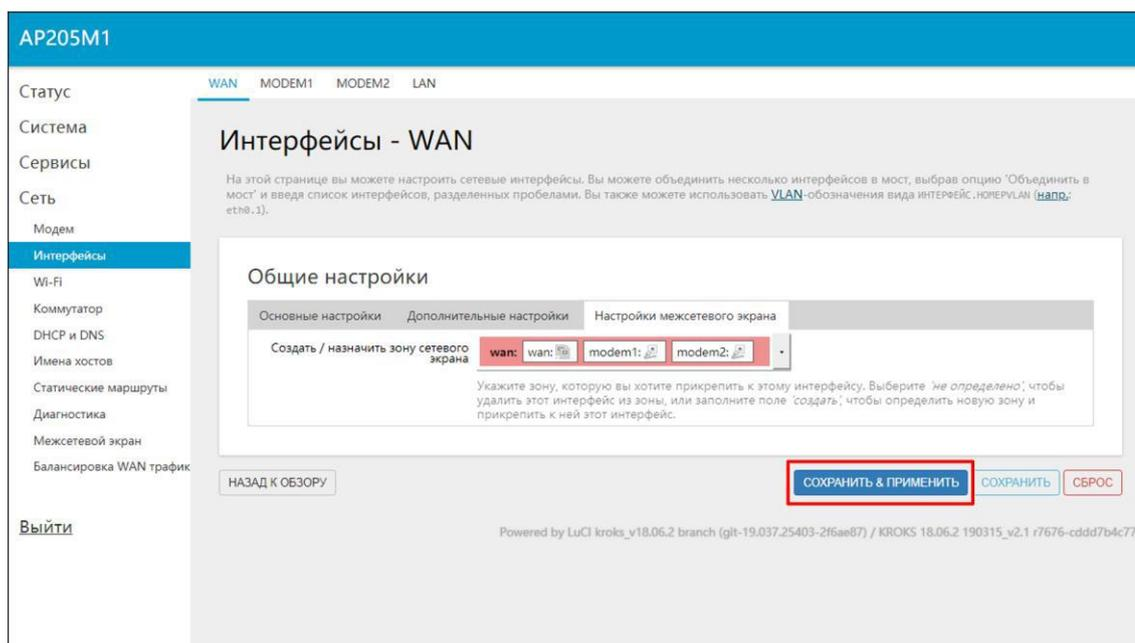
Рисунок 3.4.5 – Настройка сетевого экрана подключения по протоколу L2TP
