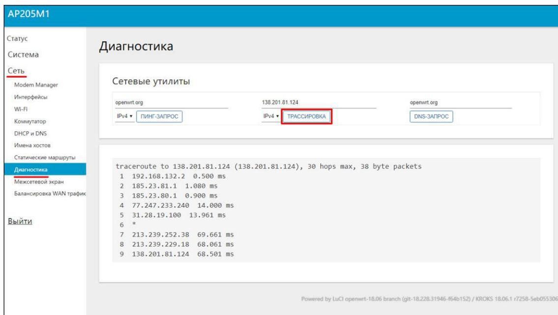
Рисунок 6.5.2 – Определение маршрута следования пакета в сети
