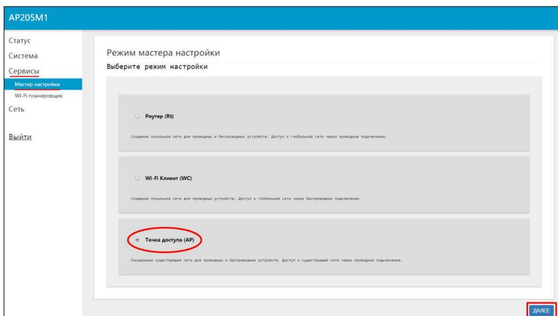
Рисунок 2.7.1 – Мастер настройки роутера в режиме точки доступа
