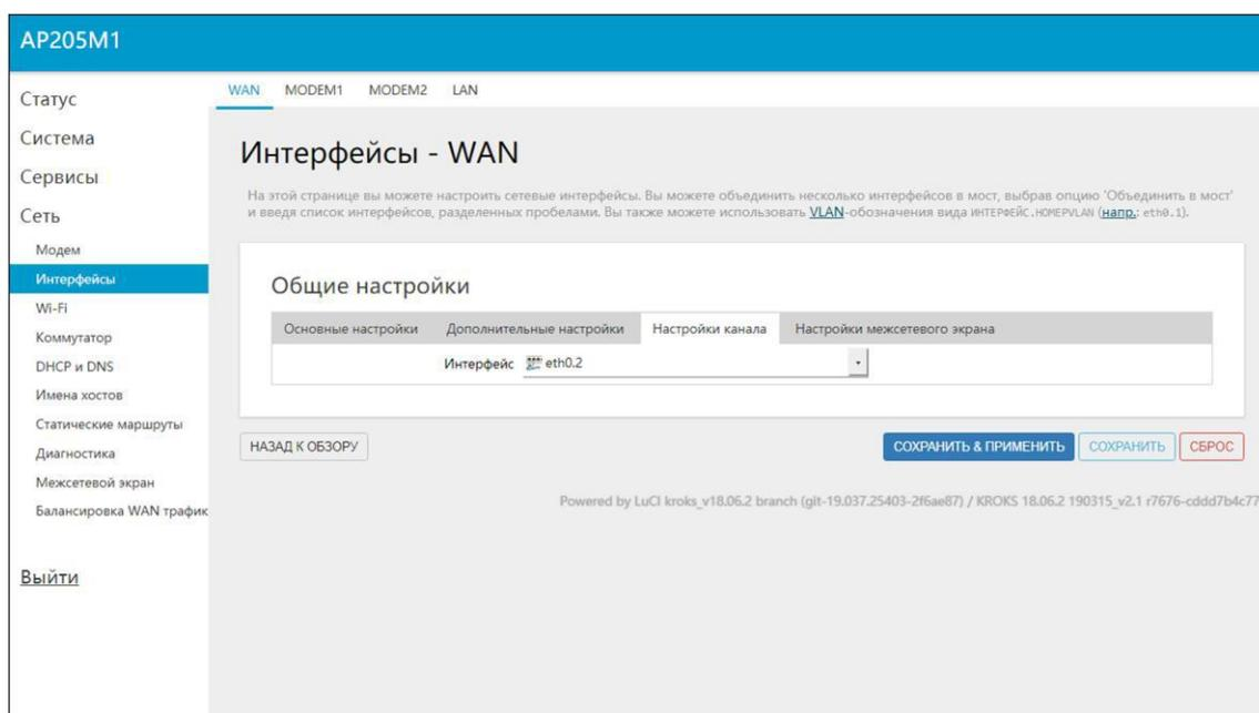
Рисунок 3.3.11 – Настройка канала со статическим IP-адресом
