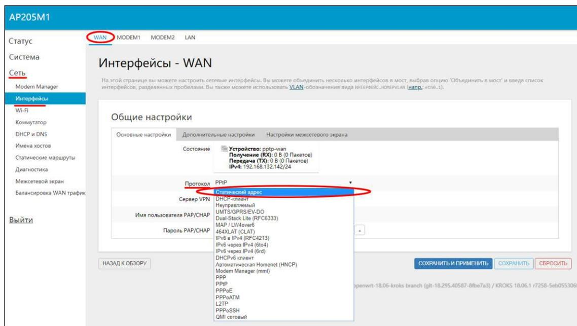
Рисунок 3.2.1 – Выбор протокола подключения со статическим IP-адресом
