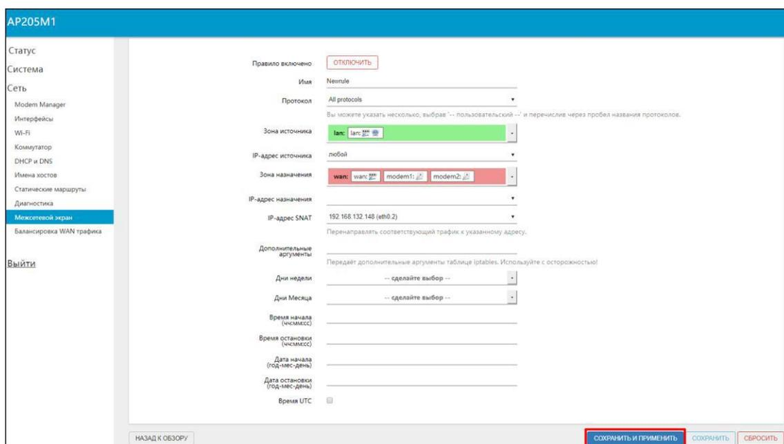
Рисунок 7.3.3 – Расширенные настройки правила использующего метод SNAT
