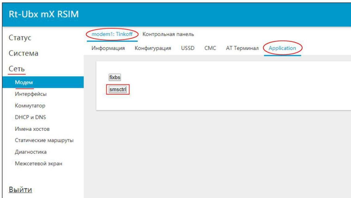
Рисунок 5.9.1 – Прикладная программа управления модемом по SMS
