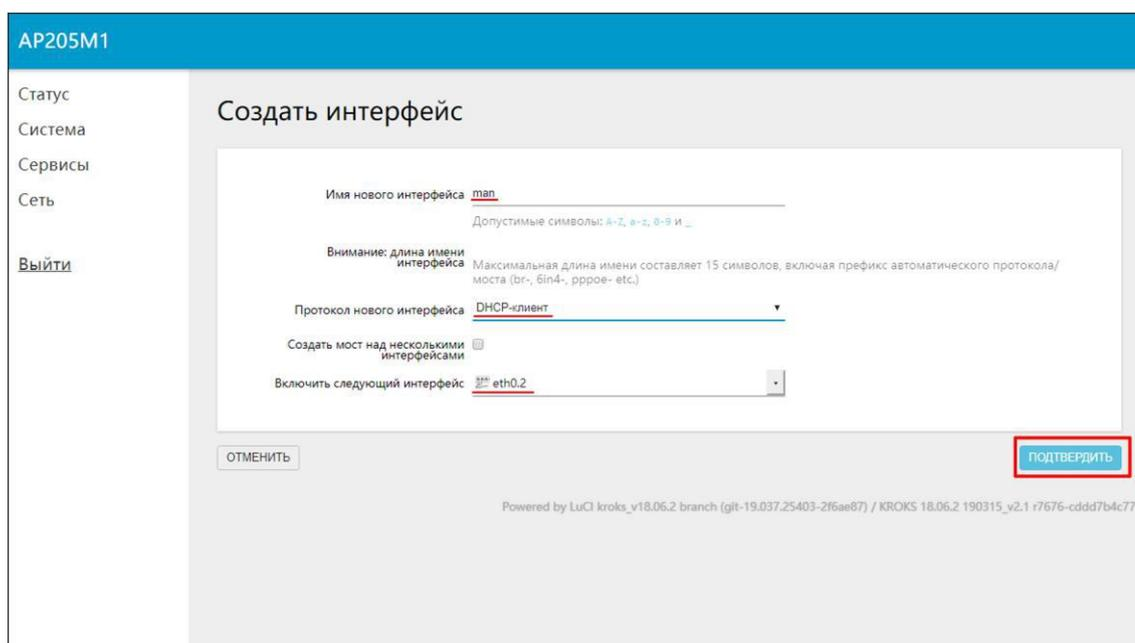
Рисунок 3.4.8 – Создание интерфейса man с динамическим IP-адресом
