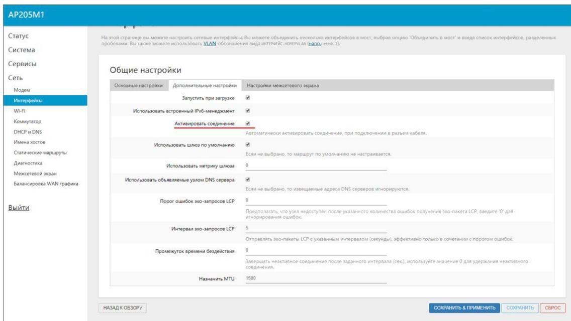
Рисунок 3.3.4 – Дополнительные настройки для протокола PPtP
