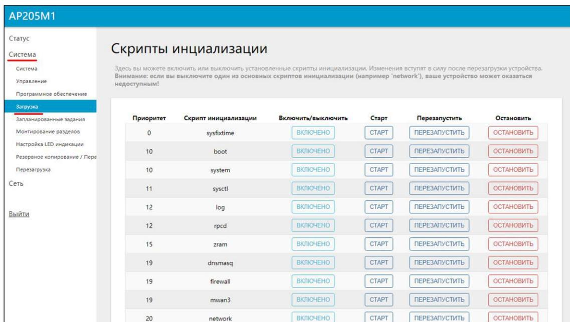
Рисунок 9.3.1 – Перечень процессов при загрузке роутера
