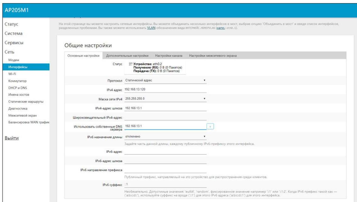
Рисунок 3.4.9 – Основные настройки интерфейса man со статическим IP-адресом
