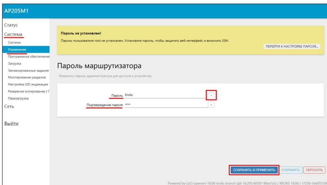
Рисунок 1.3.1 – Установка нового пользовательского пароля на Web-интерфейс роутера
