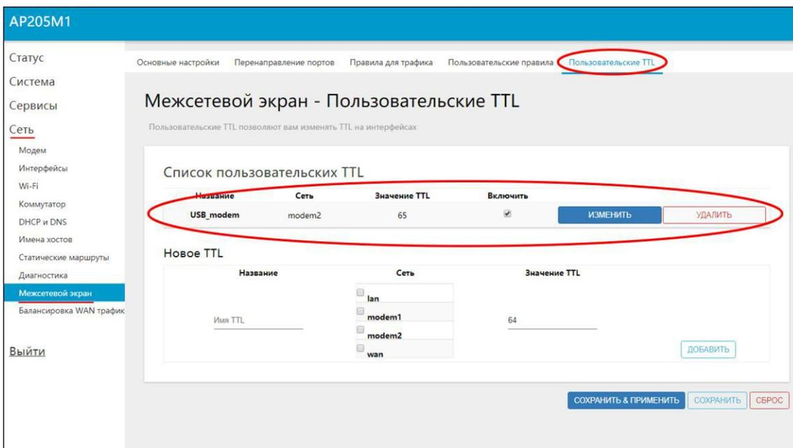
Рисунок 7.5.4 – Отображение пользовательских TTL в web-интерфейсе роутера
