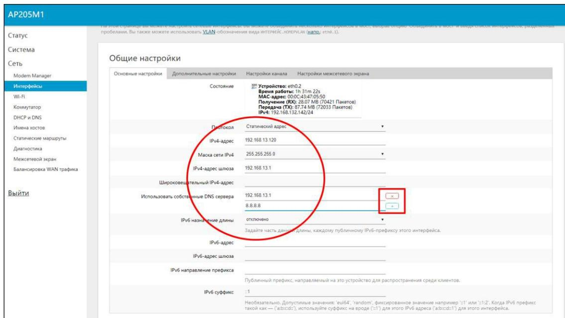
Рисунок 3.2.3 – Ввод настроек протокола соединения со статическим IP-адресом
