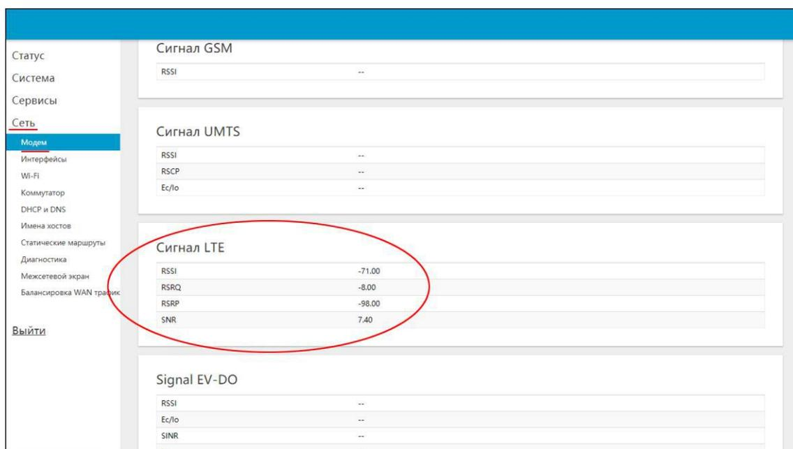
Рисунок 5.10.1 – Подробная информация об уровне принимаемого сигнала
