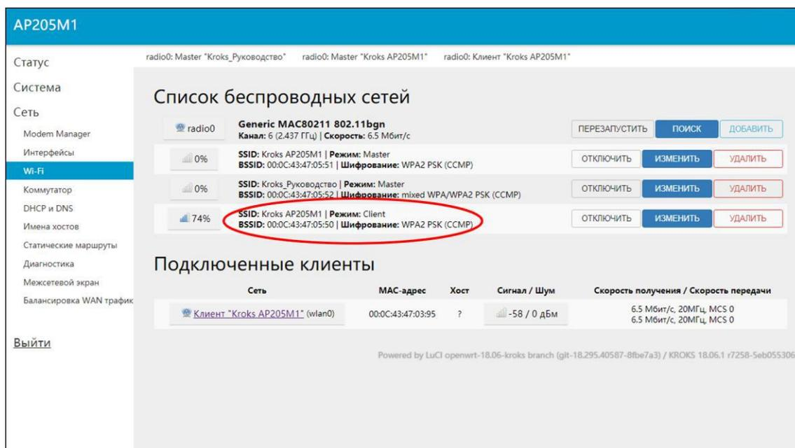
Рисунок 4.2.5 – Создан новый интерфейс, работающий в режиме клиента
