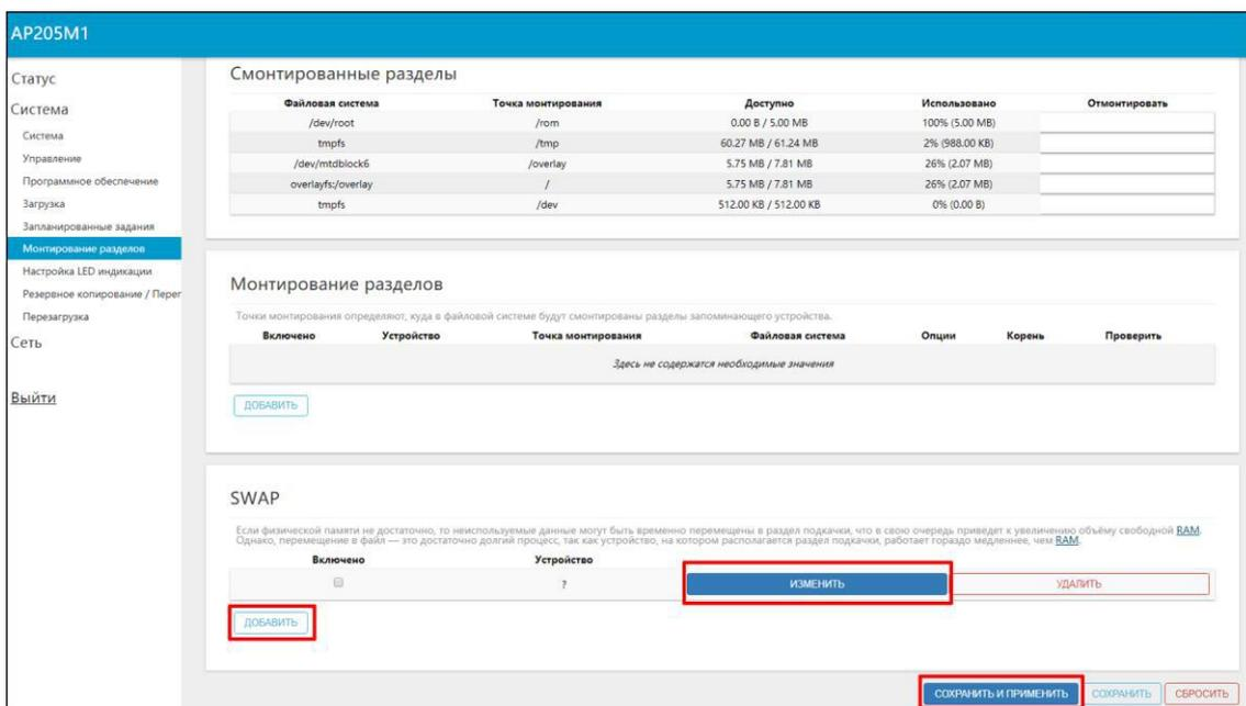
Рисунок 9.5.4 – Перемещение неиспользуемых данных в файл подкачки
