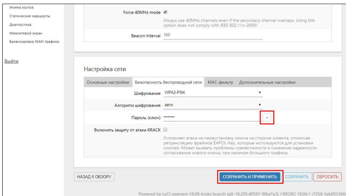
Рисунок 4.1.4 – Настройки безопасности беспроводной Wi-Fi сети
