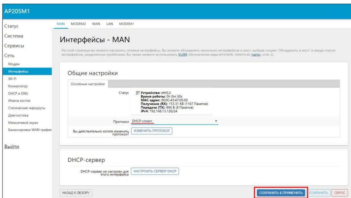
Рисунок 3.4.13 – Настройки интерфейса man с динамическим IP-адресом
