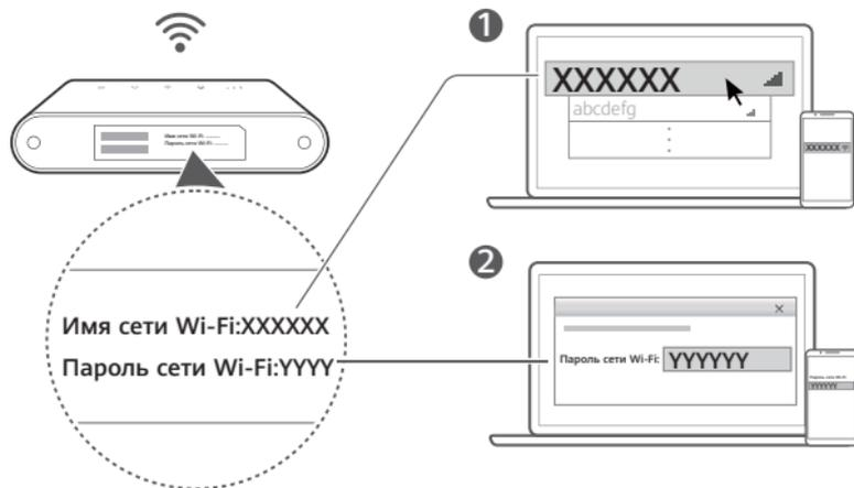
После подключения роутера к мобильной сети передачи данных Вы сможете подключить Ваш ПК или мобильный телефон к сети Wi-Fi роутера для доступа в Интернет. Имя (**Имя сети Wi-Fi**) и пароль (**Пароль сети Wi-Fi**) сети Wi-Fi по умолчанию напечатаны на наклейке, расположенной в нижней части роутера.
